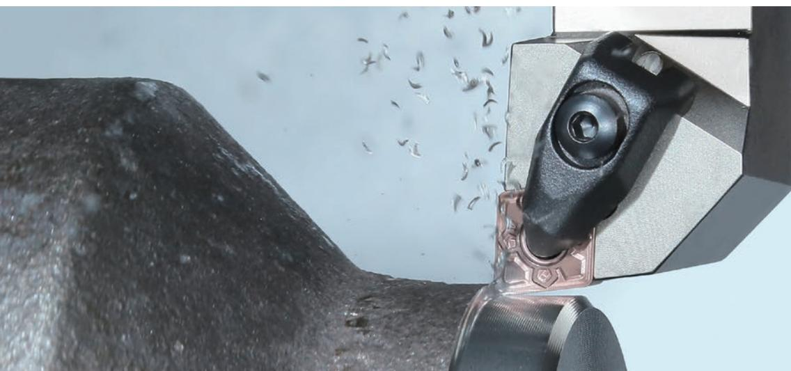
Твердый сплав с CVD-покрытием для стабильной обработки чугуна
