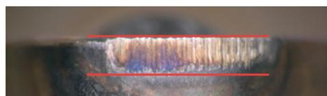
**Сопротивление выкрашиванию** Отличное сопротивление выкрашиванию благодаря специальной, высокопрочной мелкозернистой основе и остаточному сжимающему напряжению слоя покрытия CVD
