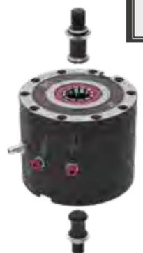
✓ Forza di serraggio 2,4 ÷ 41,6 kN / ✓ Forza di arresto fino a 80 kN / ✓ Sbloccaggio ad aria 4 ÷ 7 bar / ✓ Compensazione assiale e radiale grazie alla pinza elastica integrale / ✓ Doppio centraggio per tirante per massima rigidità / ✓ Pulizia ad aria / ✓ Chiavetta antirotazione /
