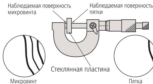
Проверка микрометра на плоскостность и параллельность торцов пятки и микрометрического винта: плоскостность определяется прямолинейностью и равноотдаленностью интерференционных полос; параллельность - количеством интерференционных полос.
