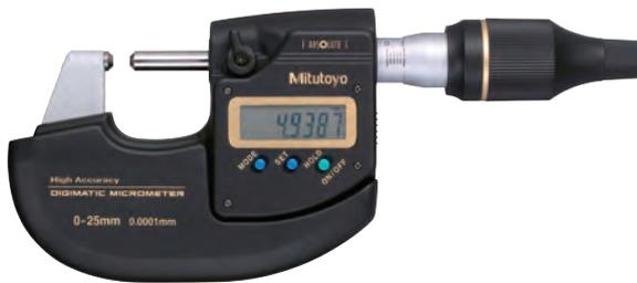
Высокоточный микрометр с теплозащитным кожухом (стандартная принадлежность)
