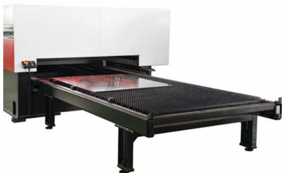
**Станина.** В качестве станины станка используется сварная рамная конструкция из стали. Продолжительный срок сохранения точности станка поддерживается за счёт снятия внутренних напряжений станины при помощи технологии вибрационного старения.
