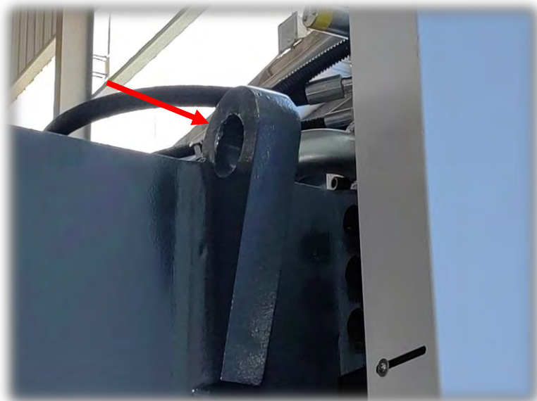
Расположение проушин для подъема пресса (левая сторона пресса)
