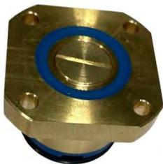
Направляющий ролик в латунном корпусе. Замена не реже чем через 1000 часов резания, при нормальном состоянии направляющей канавки. Обязательное обслуживание во время смены проволоки
