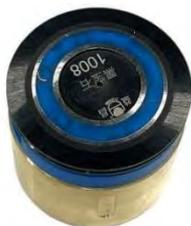
Односторонний направляющий ролик для станков. Замена не реже чем через 1000 часов резания, при нормальном состоянии направляющей канавки. Обязательное обслуживание во время смены проволоки.
