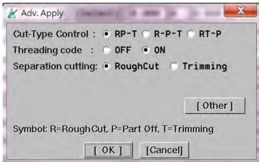
Обозначения: R= черновой проход, P= Деталь ,T=Обрезка
