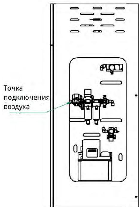
Рисунок 14-4 Подключение воздуха
