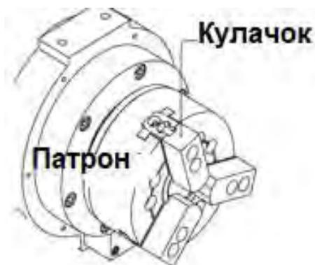
Патрон может фиксировать заготовку с помощью 3 кулачков, которые приводятся в действие гидравлическим давлением и т. д., как показано на рисунке.
