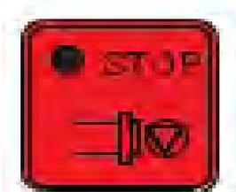
При нажатии на эту кнопку вращение шпинделя остановится. Эта кнопка действует при управлении станком вручную (режимы ручного управления, маховичка и возврата в исходное положение осей).
