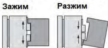
Если кулачки зажимают заготовку по наружной поверхности заготовки, то они двигаются внутрь, заготовка будет зажата для фиксации. Если кулачки перемещаются в противоположном направлении, то заготовка будет разжата.
