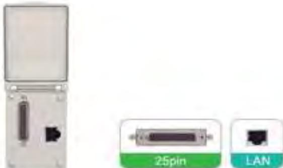
Разъемы, соединяющие RS-232C/LAN PORT и внешнее устройство ввода/вывода, расположены на главной панели управления станка.
