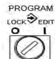
Этот переключатель в положении LOCK запрещает редактирование существующей программы, также невозможно сбросить систему координат, вводить данные в MDI и изменять параметры. Этот переключатель используется для защиты существующих данных ЧПУ.
