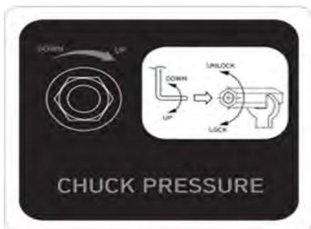
Давление для зажима кулачков патрона зависит от рабочего давления гидравлической жидкости, которое определяется настройкой клапана регулировки давления патрона, установленного в передней части станка.
