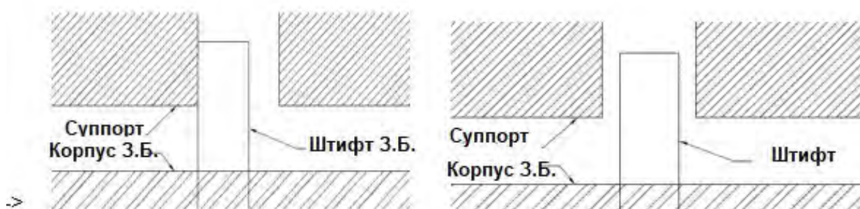
Рис.33 Перемещение штифта программируемой задней бабки
