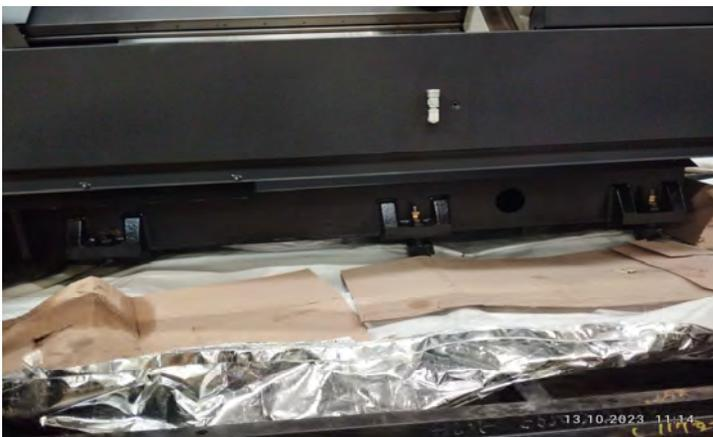
Теперь возможно установить под станину балки и разгрузить станок с палетой с грузовика. Крепить стропы к палете не рекомендуется, так как она имеет слабое сопротивление на изгиб.
