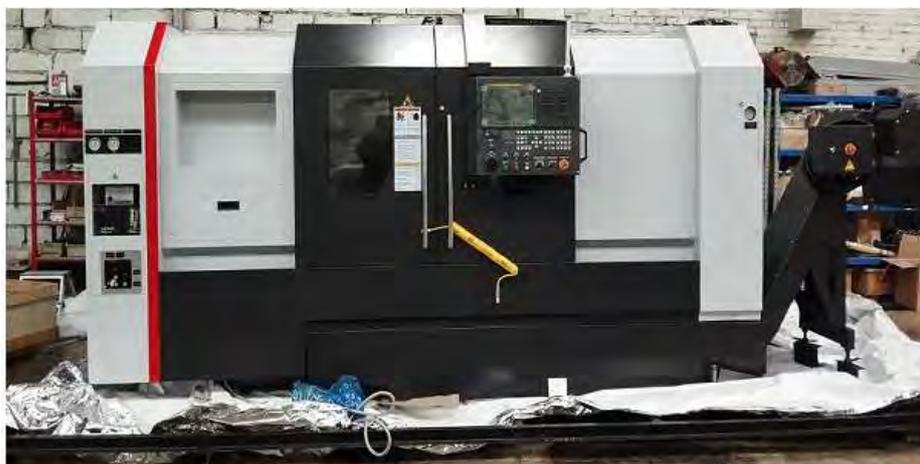
После извлечения бака СОЖ с конвейером открывается доступ к опорам станка для удаления гаек, крепящих станок к палете.
