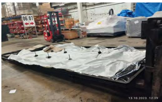
После извлечения палеты из-под станка, его можно перенести на его постоянное место и установить на крайние опоры (две справа и две слева). Пятаки (9 шт) находятся в коробке, которая лежит на конвейере в рабочей зоне станка. Необходимо установить на опоры таким образом, чтобы от пола до поверхности станины над пятаксом было расстояние 70 мм. Бак СОЖ и конвейер не устанавливаются в станок до приезда сервисного инженера.
