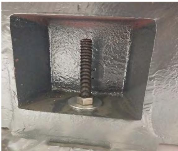
Для получения доступа к местам крепления станины к паллете необходимо извлечь бак СОЖ с конвейером уборки стружки (при наличии).
