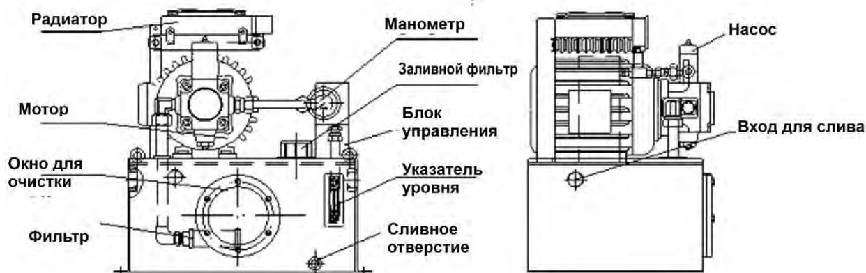
Рисунок 4.2 Схема гидробака
