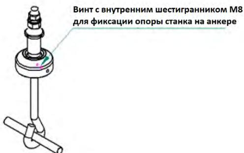
Установка анкерный болтов, разрез.
