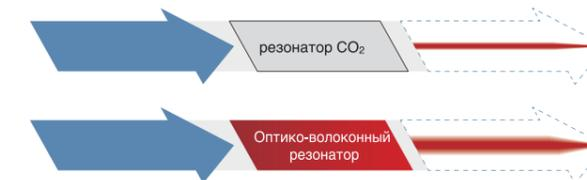
Уровень эффективности преобразования из электричества в лазер
