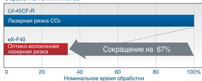
Производительность была увеличена вдвое благодаря технологиям управления и подачи, оптимизированным для обработки листов средней и большой толщины.
