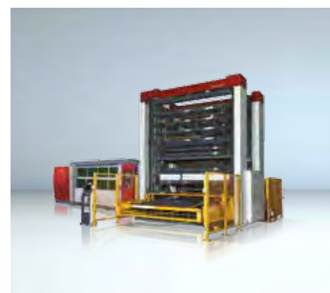
Погрузка и разгрузка со встроенной башенной системой хранения
